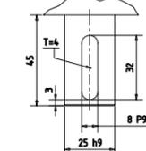
Welle Rund mit Querbohrung Ø25h9
