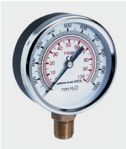
Die Manometer sind speziell für die Messung von niedrigen Drücken in mbar, nach EN 837-3 oder hohen Drücken in bar konzipiert. Sie sind geeignet für den Einsatz an Erdgasverbrennungsanlagen und zur Druckmessung von nicht korrosiven Flüssigkeiten im gasförmigen Zustand.
