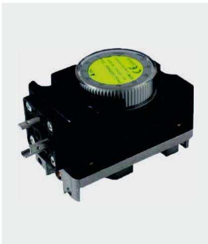
Die kompakten Gas- und Luftdruckwächter CPE überwachen den Druck und unterbrechen den elektrischen Steuerkreis bei Über- und Unterschreitung der gewünschten Sollwerte. Die Druckeinstellungen sind leicht ablesbar und einstellbar. Die Schalter sind robust und mit einem langlebigen Kunststoff-Elektrogehäuse und einer Aluminium-Druckgussbasis gefertigt.
